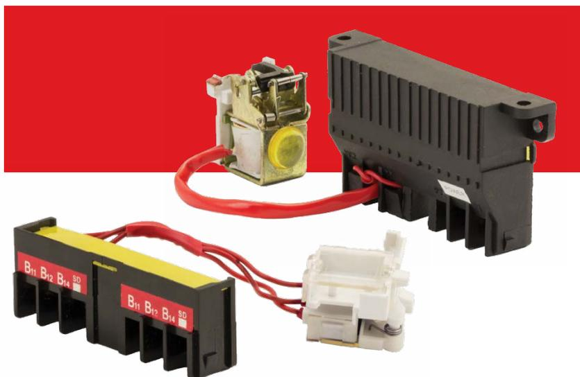
Выключатели ВА-99М EKF Basic могут комплектоваться дополнительными устройствами: независимыми расцепителями, расцепителями минимального напряжения, дополнительными и аварийными контактами, ручным поворотным приводом и электроприводом и др.
