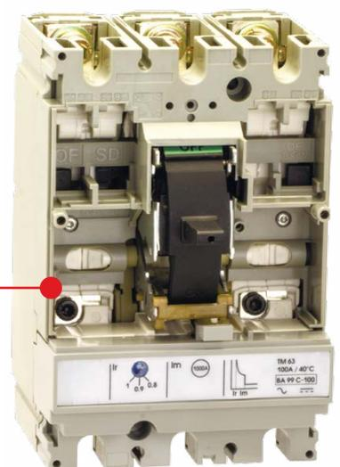
Автоматические выключатели ВА-99С EKF PROxima предназначены для нечастых оперативных включений и отключений тока в нормальном режиме, а также для защиты от токов перегрузки и коротких замыканий в различных электроустановках с номинальным рабочим напряжением 400 В переменного тока частотой 50 Гц с токами от 12,5 до 630 А.
