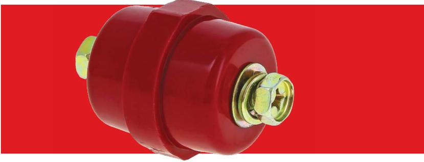
Шинные изоляторы серии SM применяются для крепления токопроводящих шин внутри силовых шкафов или других устройств, для неподвижной фиксации и изоляции частей, находящихся под напряжением, от корпуса и панелей сборки с последующим подключением силовых проводников для распределения электроэнергии внутри щита. Крепление шинного изолятора осуществляется с помощью болта и шайбы, входящих в комплект поставки, к монтажной пластине или корпусу с одной стороны и к токоведущей шине – с другой.
