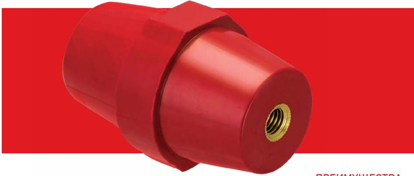
Шинные изоляторы серии SM применяются для крепления токопроводящих шин внутри силовых шкафов или других устройств, для неподвижной фиксации и изоляции частей, находящихся под напряжением, от корпуса и панелей сборки с последующим подключением силовых проводников для распределения электроэнергии внутри щита. Крепление шинного изолятора осуществляется с помощью болта и шайбы, к монтажной пластине или корпусу с одной стороны и к токоведущей шине – с другой.
