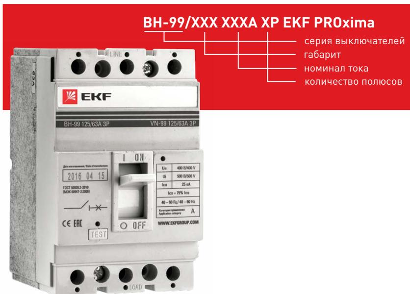
Выключатели нагрузки ВН-99 EKF PROxima выполнены в корпусе автоматического выключателя ВА-99 и предназначены для нечастых оперативных включений и отключений тока в нормальном режиме. Выключатели могут применяться в электроустановках с номинальным напряжением до 400 В переменного тока частотой 50 Гц с токами до 800А. Гарантийные обязательства составляют 5 лет.
