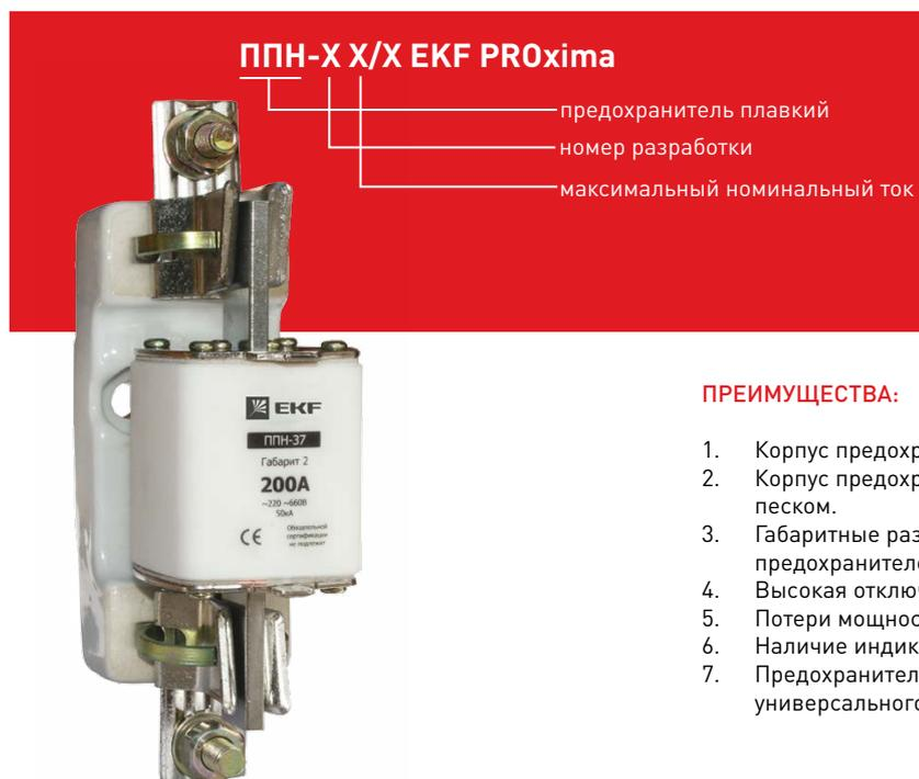
Предохранители плавкие ППН EKF PROxima предназначены для защиты кабельных линий и промышленных электроустановок от токов перегрузки и короткого замыкания. Предохранители применяются в электрических сетях переменного тока частотой 50 Гц с напряжением до 660 В и устанавливаются в низковольтные комплектные устройства, например в распределительные панели ЦО-70, вводно-распределительные устройства ВРУ1, шкафы распределительные силовые ШРС1 и т. п.
