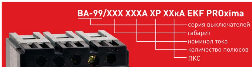
Выключатели автоматические ВА-99 EKF PROxima предназначены для нечастых оперативных включений и отключений тока в нормальном режиме, а также защиты от токов перегрузки и коротких замыканий распределительных сетей и электродвигателей. Выключатели могут применяться в электроустановках с номинальным напряжением до 400 В переменного тока частотой 50 Гц с токами от 12,5 до 1600 А. Выключатели ВА-99 EKF PROxima имеют шесть исполнений корпуса. Гарантийные обязательства составляют 5 лет.
